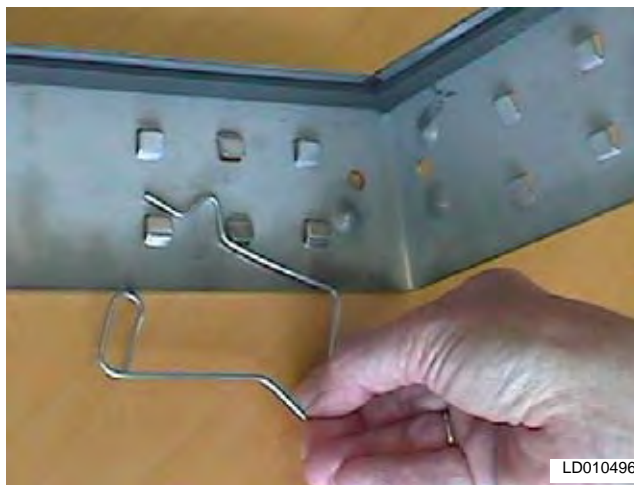
FIG. 4-26 – INSTALL LATCH P//N 315-004-000
