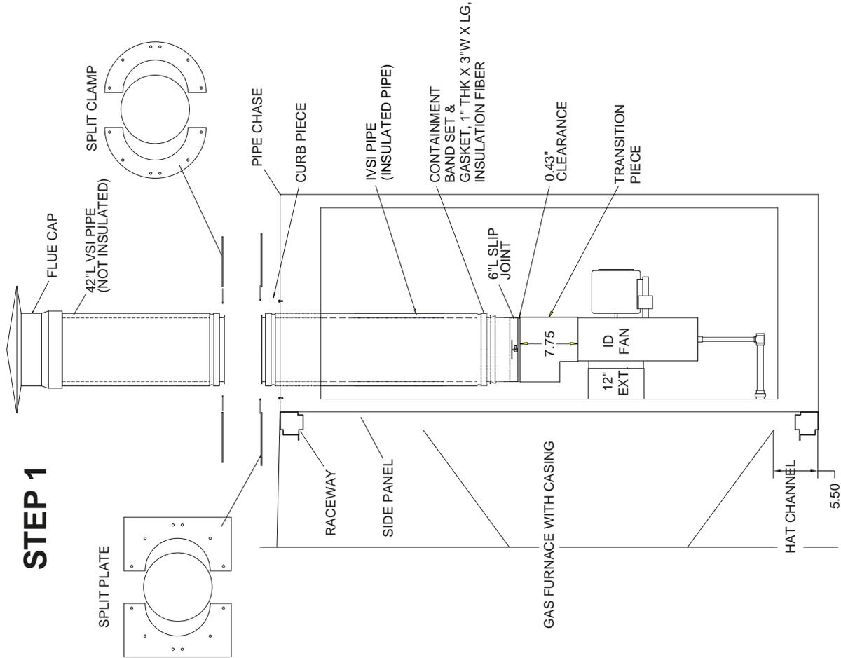
**FIG. 3-23 – GAS FURNACE FUEL VENTING SYSTEM**
