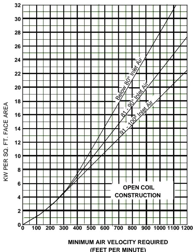
FIG. 3-25 – MINIMUM AIR VELOCITY REQUIRED FOR SAFE OPERATION
